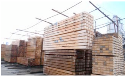
製材品に散水することで、乾燥前の内部割れ予防処理をしている。(実験中)
