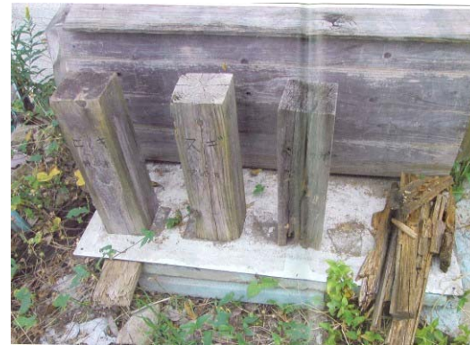
▲屋外にさらして4年後の様子。 左から 檜・杉・ベイツガ・ホワイトウッド
